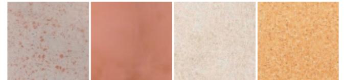
De gauche à droite : la chape poncée et la peinture terracotta réalisées avec des tuiles concassées, le faux-plafond en fibre de bois compressée, les panneaux de liège servant à l'affichage.
